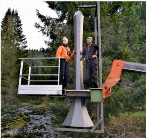
Prototype d'un instrument d'écoute en acier (fabrication des instruments auditifs définitifs en laiton). Réalisation d'un test acoustique en dehors de la ville, au-dessus d'une rivière aux caractéristiques hydrauliques et à la largeur comparables à celles de la rivière Bienne, à l'endroit où la passerelle sera installée ultérieurement.
